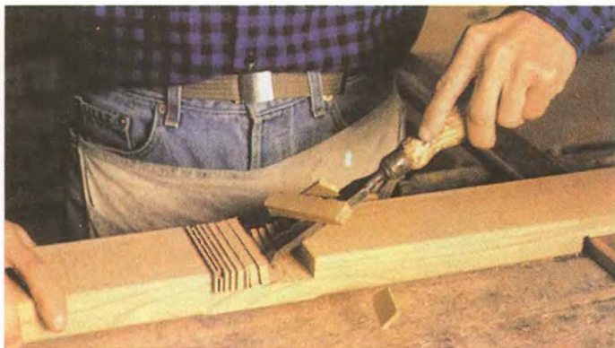
Изготовление гнезда соединения стойки и средника начинаю с серии поперечных пропилов.
