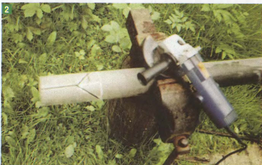
Отрезание болгаркой от оцинкованной трехдюймовой трубы лап якоря.
