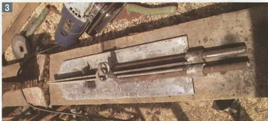
Шкворень задвижки ограничен в движении приваренными стальными накладками.
