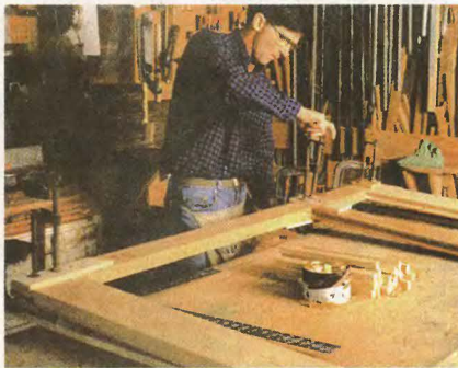
Стойки и все перемычки склеиваю.
