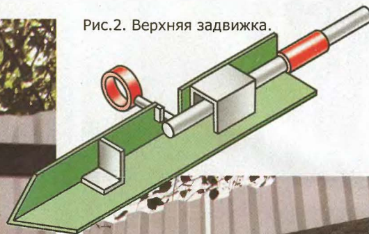
Шкворень задвижки ограничен в движении приваренными стальными накладками.
