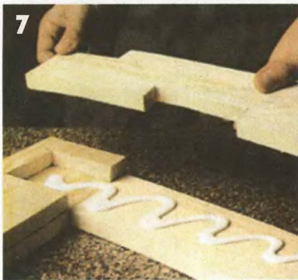
7 К наружным деталям E, K, M крепят средние слои деталей рамы и вертикальных связей.
