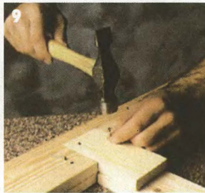
9 Крепление деталей среднего слоя лучше произвести гвоздями длиной не более 25 мм, а третьего слоя — не более 40 мм.
