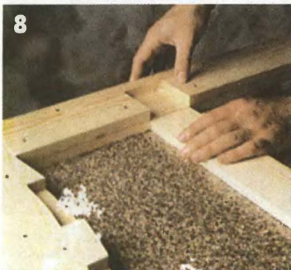
8 Соединения между деталями выполняют врубкой вподерева.
