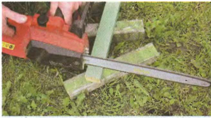
При изготовлении пазов после разметки в несколько этапов я выбирал древесину цепной пилой.
