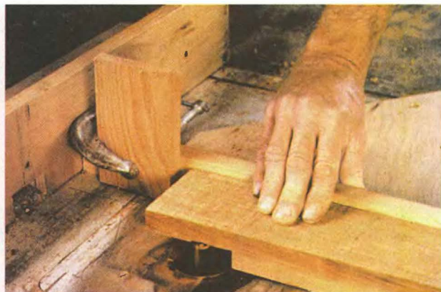
Зачистка соединения на фрезерном станке.
