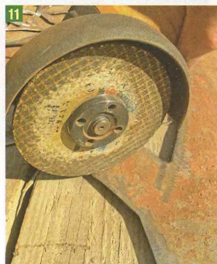
8 Начинаем аккуратно вырезать лишний металл, стараясь держаться как можно ближе к контуру рисунка.
